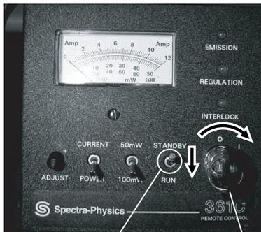
(d) Select the Run mode. (c) Turn the key switch clockwise.
